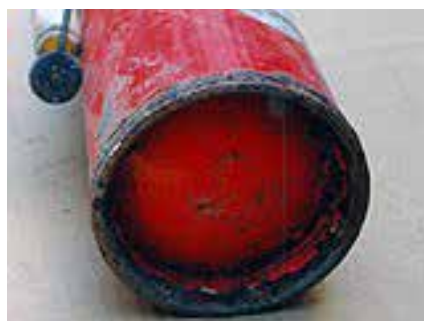
▲底が腐食している消火器
