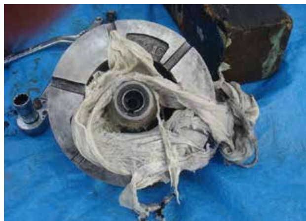
▲ポンプ内部にタオルのようなものが絡まっています。
